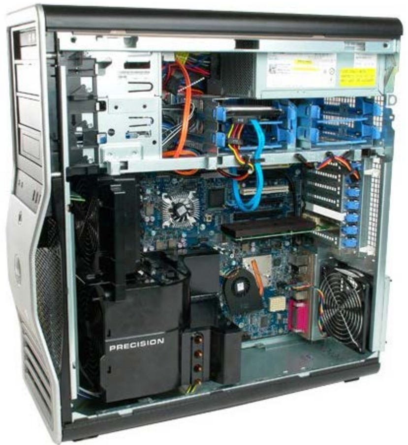
3. לחץ על יגית לוח ההחלקה לכיוון בסיס המחשב ושחרר את כונן הלוח הקדמי.
