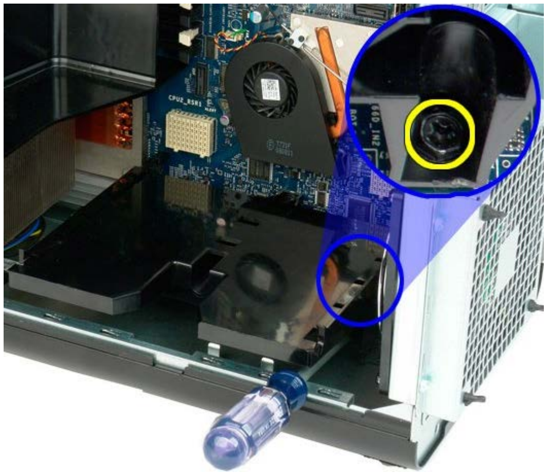
5. הסר את הבורג האחרון המחזק את מנחה יישור כרטיס ההרחבה למחשב.
