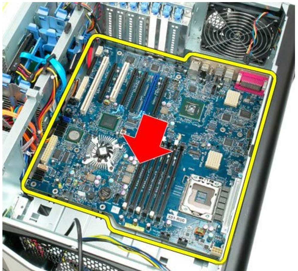
21. הרים את לוח המערכת בזווית לכיוון חלקו התחתון של המחשב.
