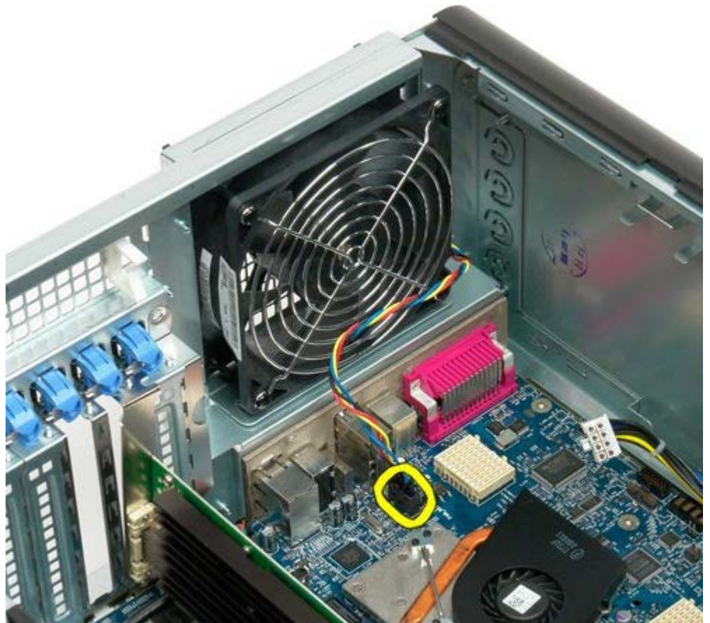
4. מצדו החיצוני של המחשב, משוך את ארבעת הגומיות השחורות כדי לשחרר את המאוורר מהמחשב.
