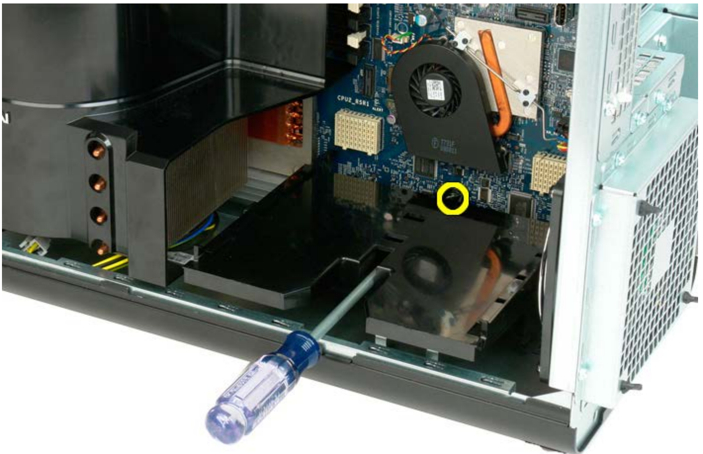
3. השתמש במברג פיליפס ארוך כדי להסיר את הבורג הראשון הנמצא לקראת מרכז המחשב.
