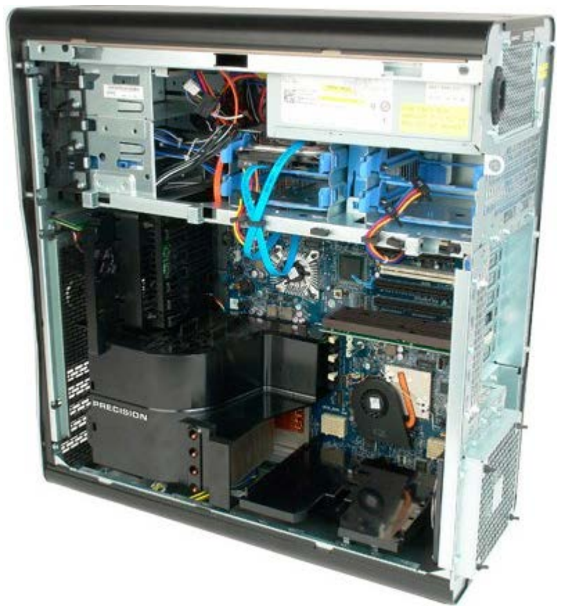
3. השתמש במברג פיליפס ארוך כדי להסיר את הבורג הראשון הנמצא לקראת מרכז המחשב.
