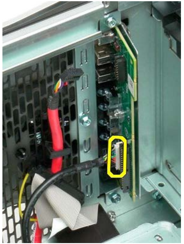
7. הסר את הברגים המחבר את לוח הקלט/פלט למארז המחשב.
