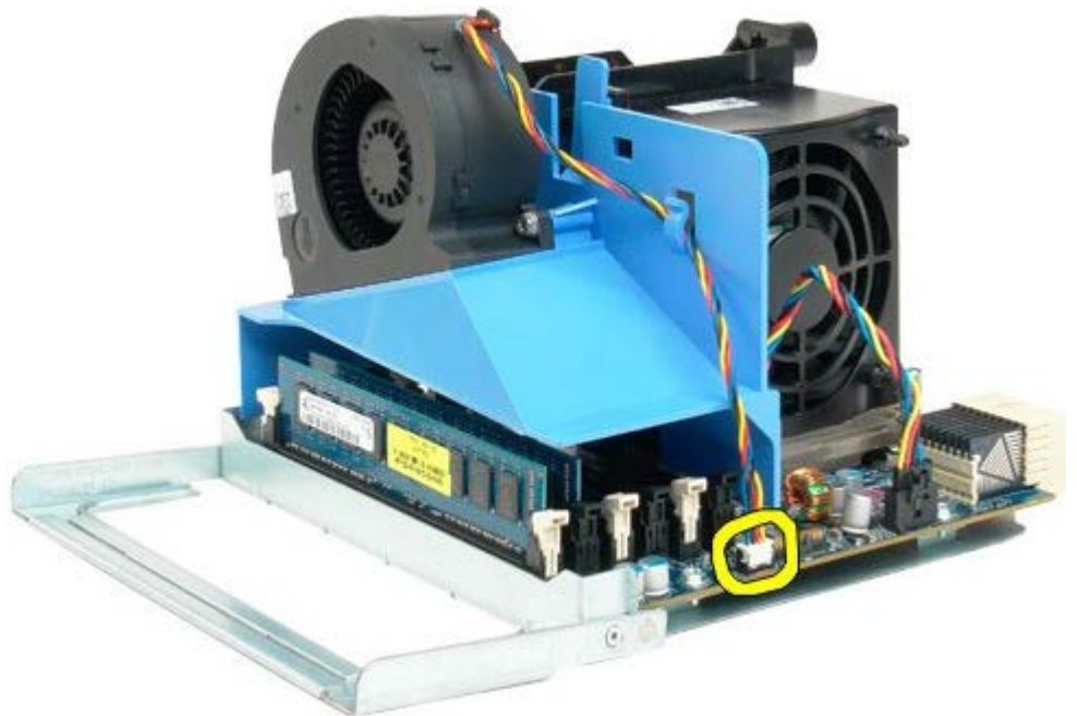
8. בעת לחיצה על הלשונית הכחולה, הסר את מכלול המעבד הכפול ממכלול המעבד הכפול.
